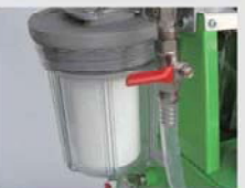
洗浄液から汚れを分離するためのフィルター。ミクロン単位の目の細かさで、非常に小さな汚れまで完全に取り除くことが可能。
