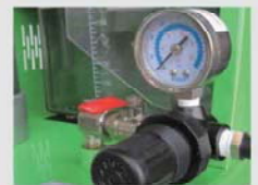
洗浄液の流入圧力はこのゲージで確認しながら調整可能。密閉式であるため、洗浄液はある程度汚れるまで再使用が可能だ。
