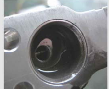
コンプレッサー内部で発生する摩耗粉や剥がれたドライレシーバー内部の活性炭など、冷媒ライン内には意外なほどの汚れが発生する。写真はエキストラクションバルブに溜まった汚れ。さらにコンプレッサーがロックするようなトラブルが発生すれば、大きな金属片なども混入しかねないのだ。
